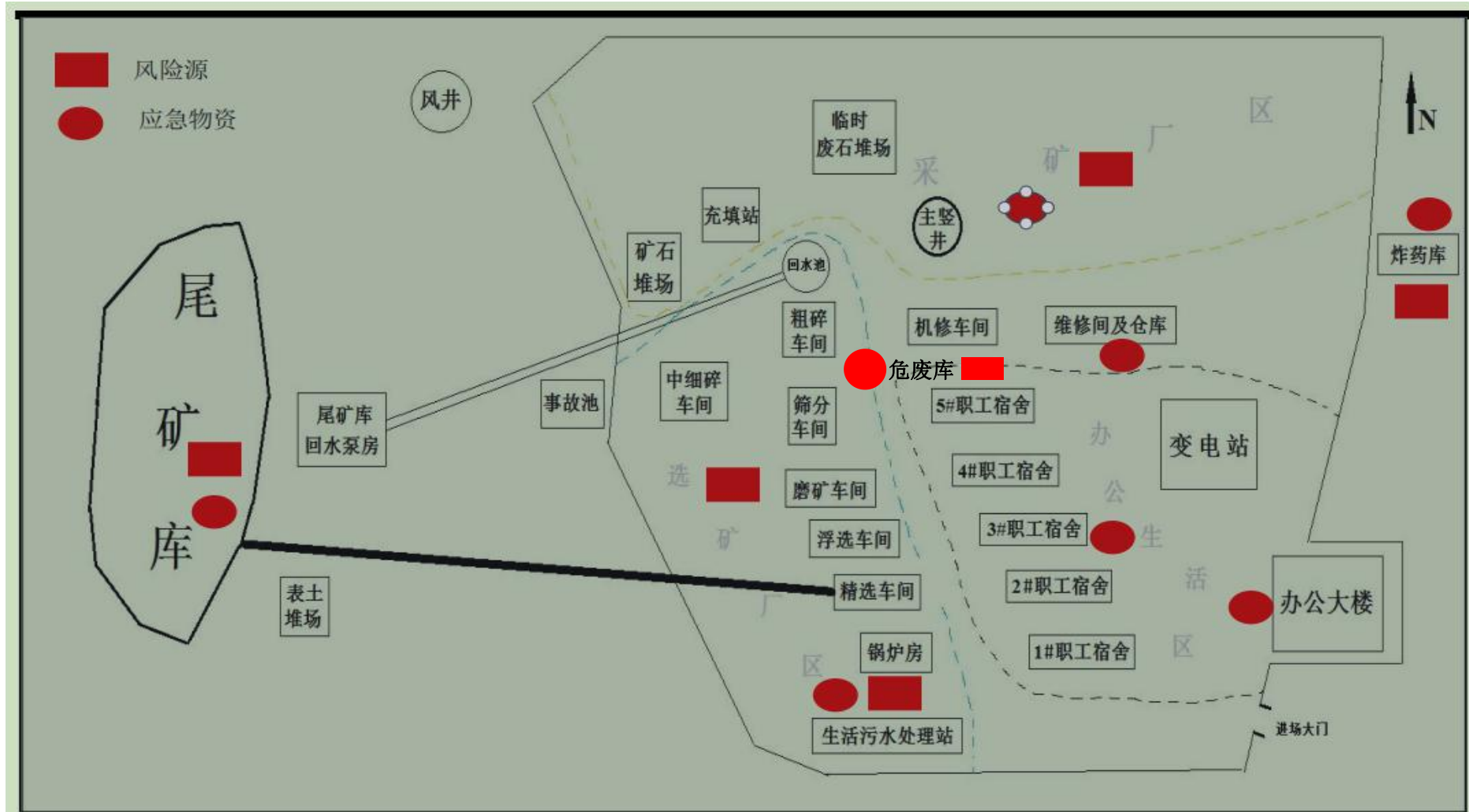
附图 4：锡林郭勒盟山金白音呼布矿业有限公司平面布置及风险源分布图
